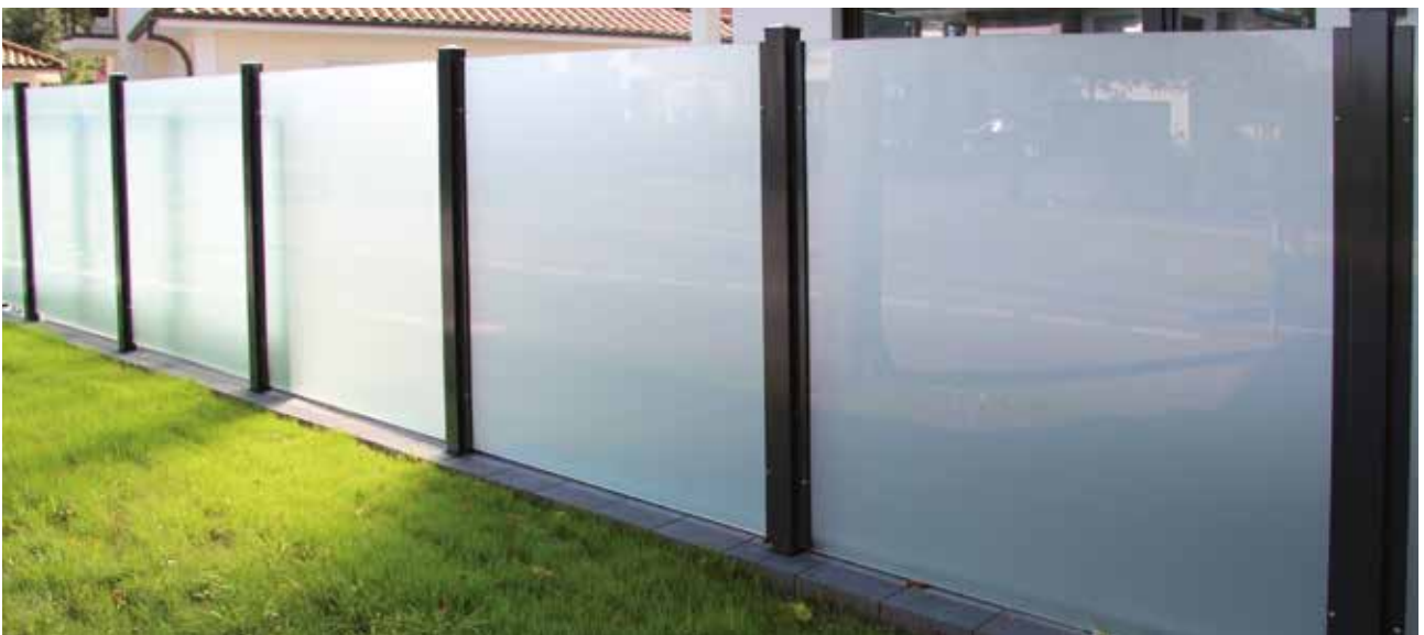
Sichtschutzelement mit Klarglas ESG 8 mm satiniert mit Quadratrohrpfosten anthrazit pulverbeschichtet
