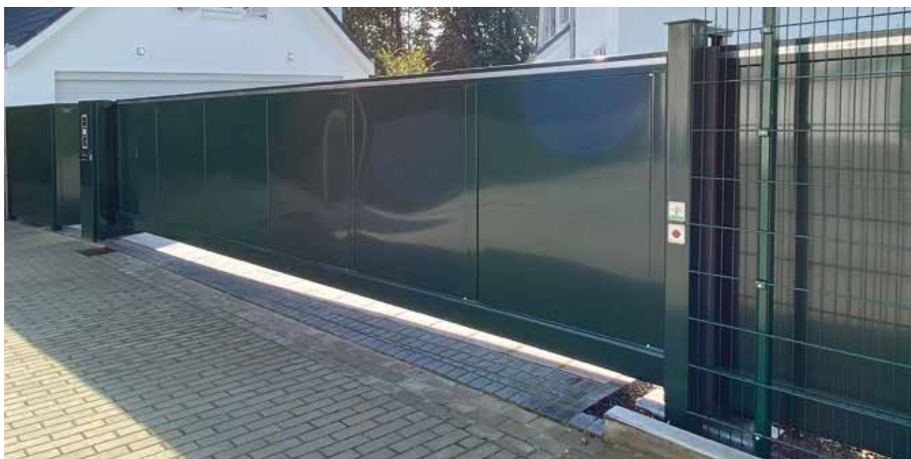
Schiebetor mit einseitiger Glatblechfüllung
