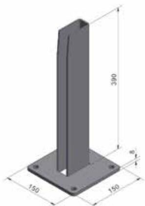
**Bodenplatte für Pfosten**
