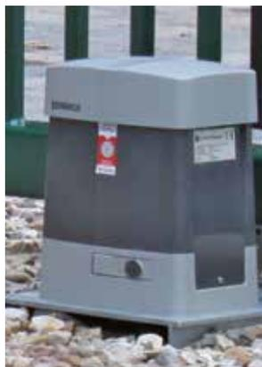
Antriebseinheit „Basic“ für Schiebetore bis 7500 mm bestehend aus Antriebsmotor GSA 1000 mit abschließbarer Notentriegelung, Zahnriemen 25/32 ATL 10 als Antriebsselement im Unterholm des Tores integriert, Schiebetorsteuerung integriert im Antriebsgehäuse, vorbereitet für Lichtschranke, Funk, automatischer Zulauf, usw., 1 Schlüsselschalter AUF/ZU, berührungslose Magnetendschalter, komplett werkseitig vormontiert.
