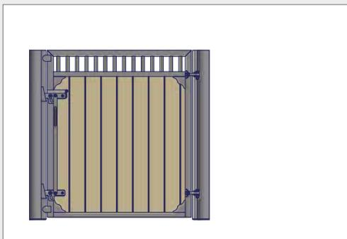
Boxendrehtür 1500 mm hoch x 1200 mm breit, Rahmen aus Vierkantrrohr 50 x 50 x 3 mm, senkrechte Sprossen aus 3/4" Rohr, lichter Gitterabstand 50 mm sichtbar, umlaufend verschweißt; unterer Türbereich aus 38 mm starker Holzfüllung, 1300 mm hoch mit Nut und Feder. Doppelhubriegel zum sicheren Öffnen der Tür. Aufhängung der Drehtür durch robuste, verstellbare Gehänge, wahlweise links oder rechts angeschlagen. Öffnungswinkel ca. 160°, lichte Breite ca. 1200 mm.
