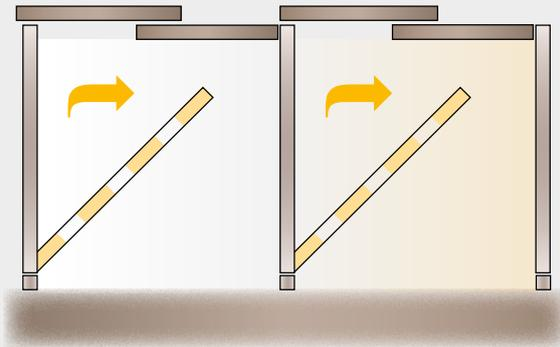
**Schwenkbare Trennwände** eignen sich zur Entmistung kompletter Boxenreihen.
