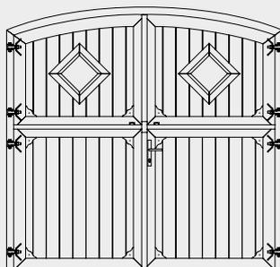
Das Growi® Stalltor mit Karofenster und Bogen ist waagrecht geteilt und besteht aus vier Teil-Bereichen. Die Holzfüllung besteht aus einer wetterfesten Trägerplatte mit 12,5 mm Deckschicht aus nordischem Nadelholz. Mit beidseitiger Drückergarnitur.
