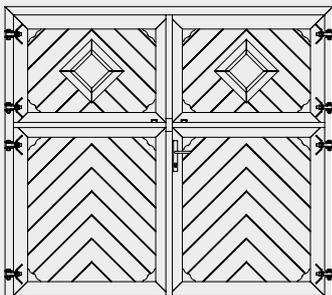
Das Growi® Stalltor in Fischgrät-Optik ist waagrecht geteilt und besteht aus vier Teil-Bereichen. Die Holzfüllung besteht aus einer wetterfesten Trägerplatte mit 12,5 mm Deckschicht aus nordischem Nadelholz. Mit beidseitiger Drückergarnitur.
