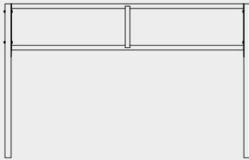
Die Abtrennung GV2 FIX ist 600 mm hoch und hat einen Rohrabstand von 480 mm. Sie besteht aus 2 waagerechten Rohren Ø 60,3 mm und wird als Abtrennung für Paddocks genutzt. **Preis ohne Pfosten.**
