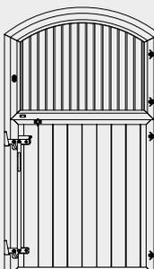
Die Growi® Stalltür mit Bogen hat die Maße 1200 x 2000/2200 mm und besteht aus zwei Teilen. Sie beinhaltet ein Drehfenster mit Schnapper und eine Tür mit Doppelhubverschluss und 30 mm Denyaholzfüllung. Der Innengitterrahmen ist herausnehmbar.
