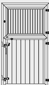
Die Growi® Stalltür mit Dreh-Kippfenster hat die Maße 1200 x 2215 mm und besteht aus zwei Teilen. Die Stalltür kann von innen und außen geöffnet werden. Sie wird mit 30 mm Denyaholzfüllung geliefert. Detaillierte Informationen zu unseren Verschlussmöglichkeiten finden Sie auf Seite 71. Der Innengitterrahmen ist herausnehmbar.
