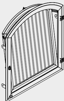
Das Growi® Dreh-Kippfenster mit den Maßen 1000 x 1000/1200 mm mit Rundbogen beinhaltet einen Innengitterrahmen. Das Fenster ist wie beim Dreh-Kippfenster mit gerader Optik zu bedienen. Der Innengitterrahmen ist herausnehmbar.
