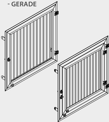
Das Growi® Drehfenster mit den Maßen 1000 x 1000 mm beinhaltet einen herausnehmbaren Innengitterrahmen. Das Growi® Doppel-Drehfenster besteht aus zwei drehbaren Rahmen, zuerst öffnet sich die Fensterscheibe und der Innengitterrahmen bleibt geschlossen. Erst dann können Sie den Innengitterrahmen separat öffnen und komplett aufschwenken. Der Innengitterrahmen ist herausnehmbar.
