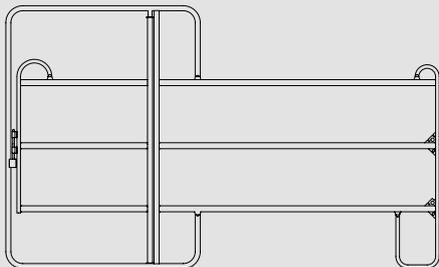
Das Panel mit Tor (Durchgangsbreite ca. 1135 mm) ist 2200 mm hoch. Es besteht aus ovalem Stahlrohr und ist in den Längen 2400/3000/3600 mm mit verriegelbarem Durchgang erhältlich. Abstand zwischen den Querstreben 419 mm. Verbindung der Panels durch Ketten und Schäkkel.
