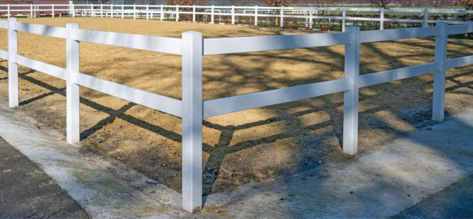
Reitplatzeinzäunung mit Kunststoffsystem S 2 mit zwei waagerechten Profilen.
