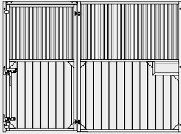
Die Growi® Pferdebox Evando besteht aus einer geradlinigen Frontwand mit Futterdurchreiche und einteiliger Drehtür mit Doppelhubriegelverschluss.
