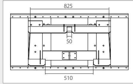
6. Schäffer-Hoflader mechanische Verriegelung, obere Einhänghöhe: 966 mm
