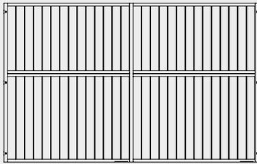
Die Growi® Trennwand Tamera ist 2300 mm hoch und komplett mit Holz gefüllt. Untere Füllung ca. 1300 mm hoch, obere Füllung ca. 950 mm hoch.
