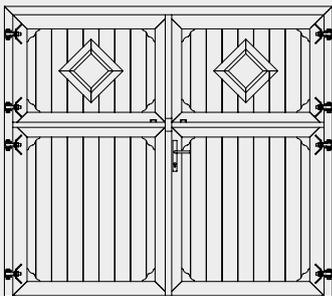
Das Growi® Stalltor mit Karo-Fenster ist waagrecht geteilt und besteht aus vier Teil-Bereichen. Die Holzfüllung besteht aus einer wetterfesten Trägerplatte mit 12,5 mm Deckschicht aus nordischem Nadelholz. Mit beidseitiger Drückergarnitur.
