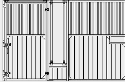
Die Growi® Pferdebox Walina hat einen Fressplatz mit zwei individuell verstellbaren Rohren. Bei der gradlinigen Frontwand ist eine Futterdurchreiche integriert. Die Tür ist mit einem Doppelhubriegelverschluss ausgestattet.
