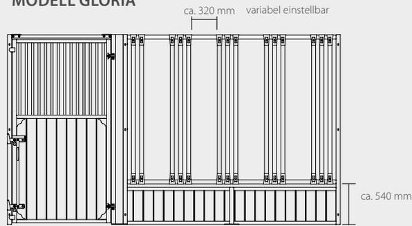
Die Growi® Pferdebox Gloria besteht aus einer geradlinigen Frontwand mit integrierten und variabel verstellbaren Fressgittern zur rationellen und artgerechten Vorlage von Heu. Die Tür ist mit einem Doppelhubriegelverschluss ausgestattet.
