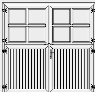
Das Growi® Stalltor mit Sprossenfenster ist waagrecht geteilt und besteht aus vier Teil-Bereichen. Die Holzfüllung besteht aus einer wetterfesten Trägerplatte mit 12,5 mm Deckschicht aus nordischem Nadelholz. Mit beidseitiger Drückergarnitur.
