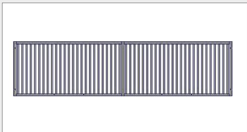
Aufsatzgitter für vorhandene, gemauerte Wände. Die Gitterfelder sind 1000 mm hoch und bestehen aus 3/4"-Rohren, die in einem lichten Gitterabstand von 50 mm verschweißt sind. Die Rahmen der Aufsatzgitter bestehen aus Quadratrohr 50 x 50 x 3 mm und U-Eisen 50 x 40 x 4 mm. Die oberste Schiene über dem Gitter ist geschlossen. Auf Wunsch fertigen wir Ihnen diese Gitter auch in allen anderen Abmessungen, soweit dieses technisch möglich ist.
