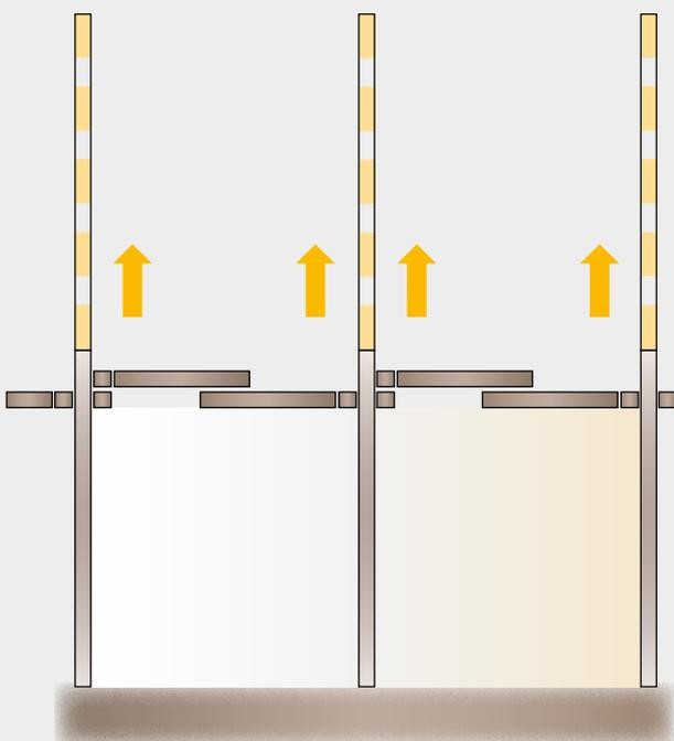
**Bei ausziehbaren Trennwänden** können die Pferde während der Arbeit auf der Stallgasse untergebracht werden.
