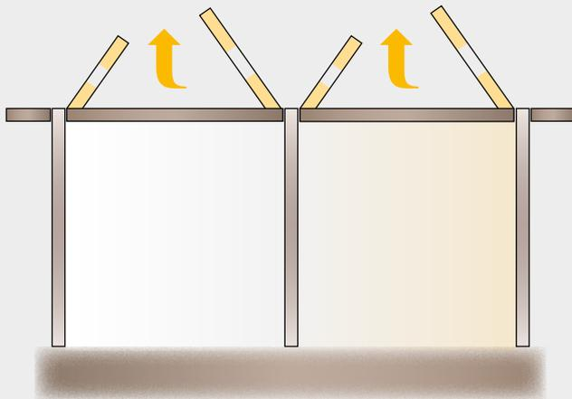
**Schwenkbare Vorderwand** zur Entmistung mit dem Hoflader einzelner Boxen von vorne. **Typ Faana.**
