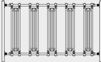
Das Sicherheits-Fressgitter 3000 besteht aus 2 Trägerrohren von 60,3 mm  $\emptyset$  mit 4 verstellbaren Aufhängungen, 4 Anschraubteilen Nr. 990117 und 5 Gitterelementen. Die Rohrlänge beträgt 2750 mm, die Montagelänge einschließlich Aufhängung max. 2950 mm. **Preis ohne Pfosten.**
