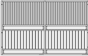
Die Growi® Trennwand Morengo ist 2300 mm hoch, hat eine Gitterhöhe von 950 mm und eine Holzhöhe von 1300 mm.
