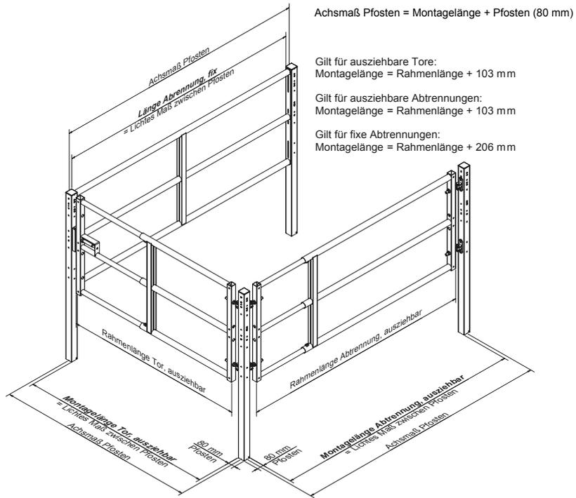
Montagelänge Tor (Lichtes Maß zwischen den Pfosten)
