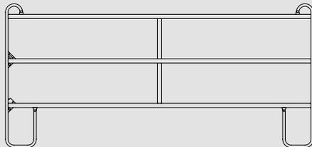
Das Panel ist 1700 mm hoch. Es besteht aus ovalem Stahlrohr und ist in den Längen 2400/3000/3600 mm erhältlich. Abstand zwischen den Querstreben 478 mm. Verbindung der Panels durch Ketten und Schäkkel.
