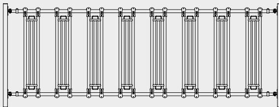
Das Sicherheits-Fressgitter 5000 besteht aus 2 Trägerrohren von 60,3 mm  $\emptyset$  mit 4 verstellbaren Aufhängungen, 4 Anschraubteilen Nr. 990117 und 8 Gitterelementen. Die Rohrlänge beträgt 4750 mm, die Montagelänge einschließlich Aufhängung max. 4950 mm. **Preis ohne Pfosten.**
