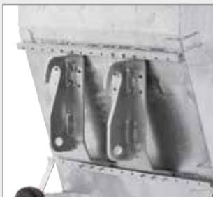
4. Weidmann hydraulische Verriegelung, obere Einhängehöhe: 915 mm
