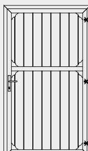
Die Growi® Stalltür mit Holzfüllung hat die Maße 1200 x 2215 mm und besteht aus einem Teil. Sie hat kein Fenster und die komplette Holzfüllung ist 30 mm stark und wird mit Denyaholzfüllung geliefert.
