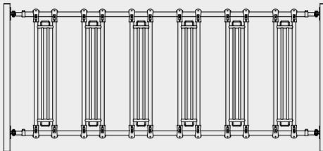
Das Sicherheits-Fressgitter 4000 besteht aus 2 Trägerrohren von 60,3 mm  $\emptyset$  mit 4 verstellbaren Aufhängungen, 4 Anschraubteilen Nr. 990117 und 6 Gitterelementen. Die Rohrlänge beträgt 3750 mm, die Montagelänge einschließlich Aufhängung max. 3950 mm. **Preis ohne Pfosten.**
