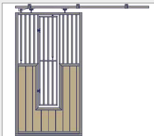
In die Schiebetür bauen wir eine verschließbare Klappe, die als Fressplatz geöffnet werden kann. Lichte Weite der Fressplatzöffnung ca. 300 mm B x 1700 mm H.
