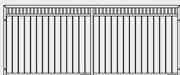
Die Growi® Trennwand Inao ist 1500 mm hoch, hat eine Gitterhöhe von 200 mm und eine Holzhöhe von 1300 mm.
