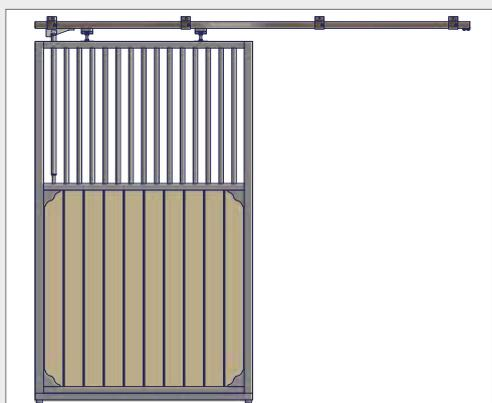
Schiebetür für Pferdebox zum Anschrauben/Dübeln an vorhandene Mauern oder Boxenwände. Schiebetür 1300 mm breit x Türrahmen 2150 mm H inkl. C-Profileschiene (3000 mm lang) 2 Laufwagen, Stopper und Schienenhalter.
