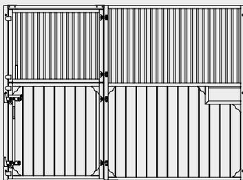
Die Growi® Pferdebox Evando besteht aus einer geradlinigen Frontwand mit Futterdurchreiche und zweiteiliger Drehtür mit Doppelhubriegelverschluss. Fenster und Tür können dadurch einzeln geöffnet werden.
