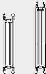
Die einzelnen Gitterelemente haben einen lichten Gitterabstand von 50 mm. Lieferung einschließlich 4 Stück Doppel-Lochschellen zur Montage an Rohren 60,3 mm  $\emptyset$ .
