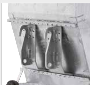
3. Weidemann hydraulische Verriegelung Obere Einhängehöhe: 915 mm
