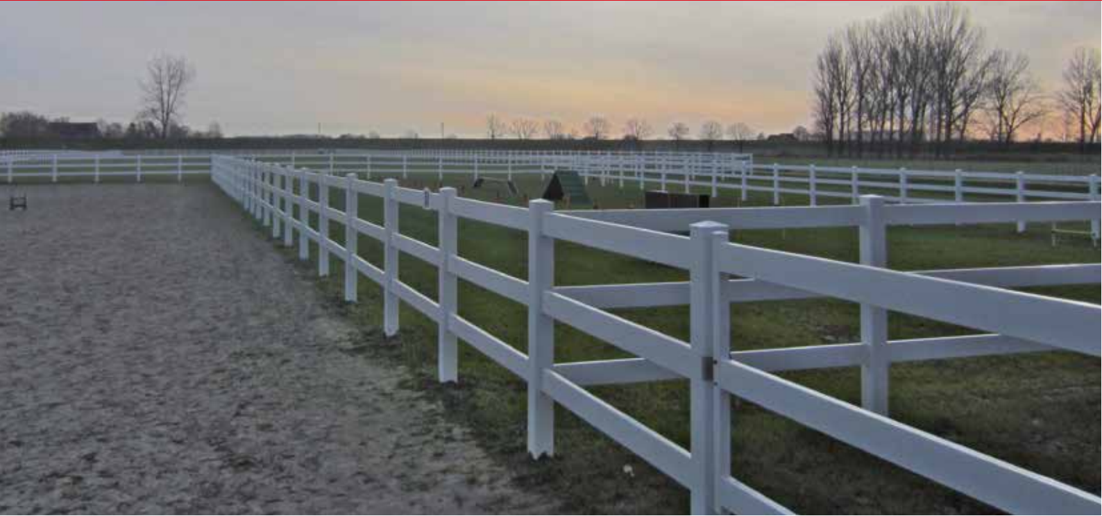
Reitplatzeinzäunung mit Kunststoffsystem S 3 mit drei waagerechten Profilen.
