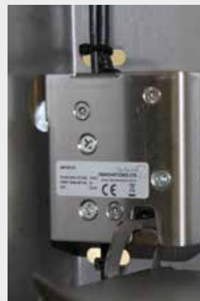
Die Steuereinheit löst die Verriegelung der Heuebene und das Futter fällt nach unten
