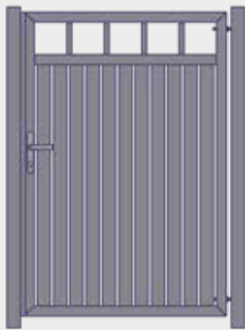
Tor mit unterbrochener Füllung, oben
